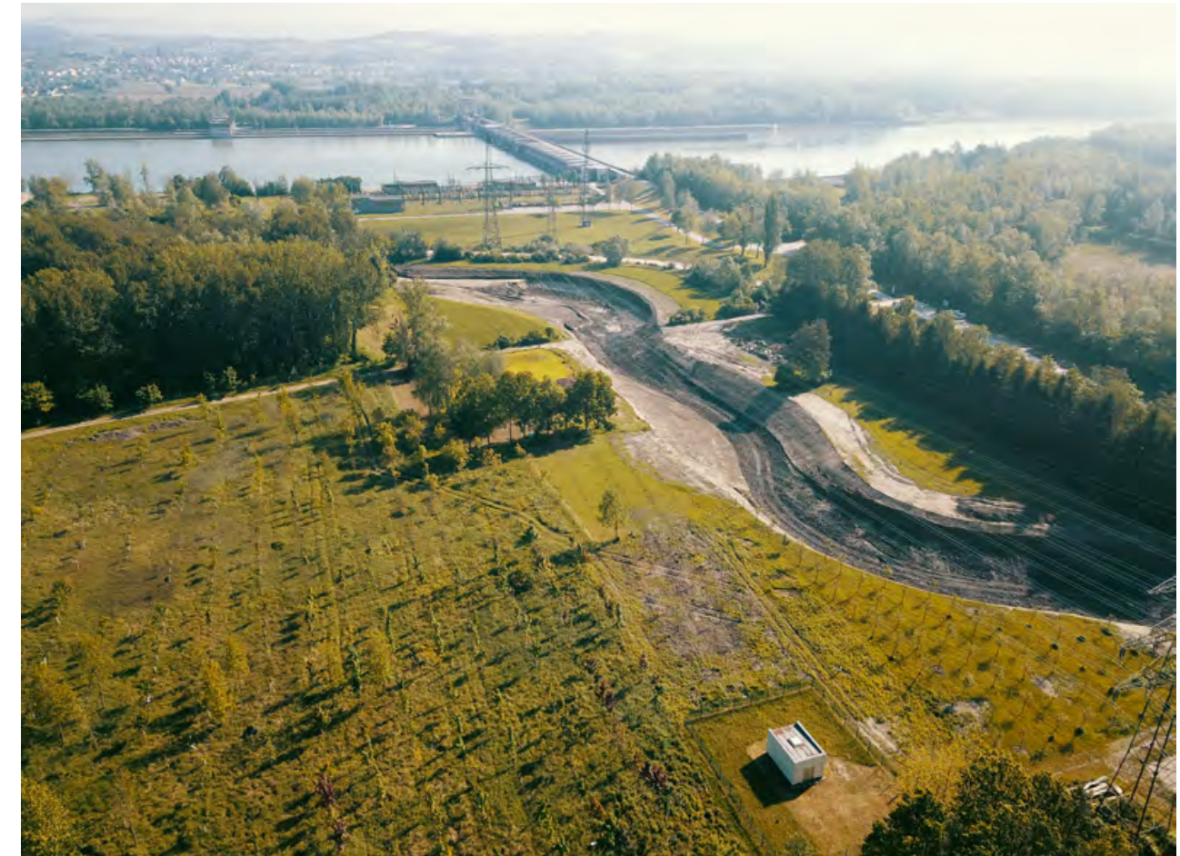
Abb. 5: Ausformung des Flussbettes (Furt, Kolk). Aufgrund der eingeschränkten Hochwasserdynamik wurde das Gewässerbett grob vorgestaltet, die Feinmodellierung erfolgt aber über die Zeit durch das Gewässer selbst.
