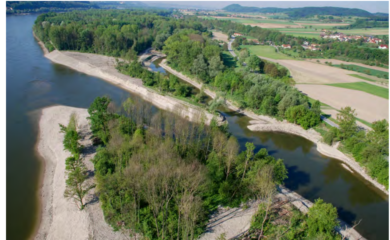
Abb. 9: Nebenarmsystem Schallemmersdorf/Grimsing. Der Rest des historischen Nebenarms am linken Donauufer bei Schallemmersdorf wurde auf einer Länge von 2 km ausgebaggert und ein großzügiger Einströmbereich hergestellt. Der neue Nebenarm mündet in den Nebenarm „Grimsing“ ein, der bereits im früheren LIFE Natur Projekt „Wachau“ reaktiviert wurde.
