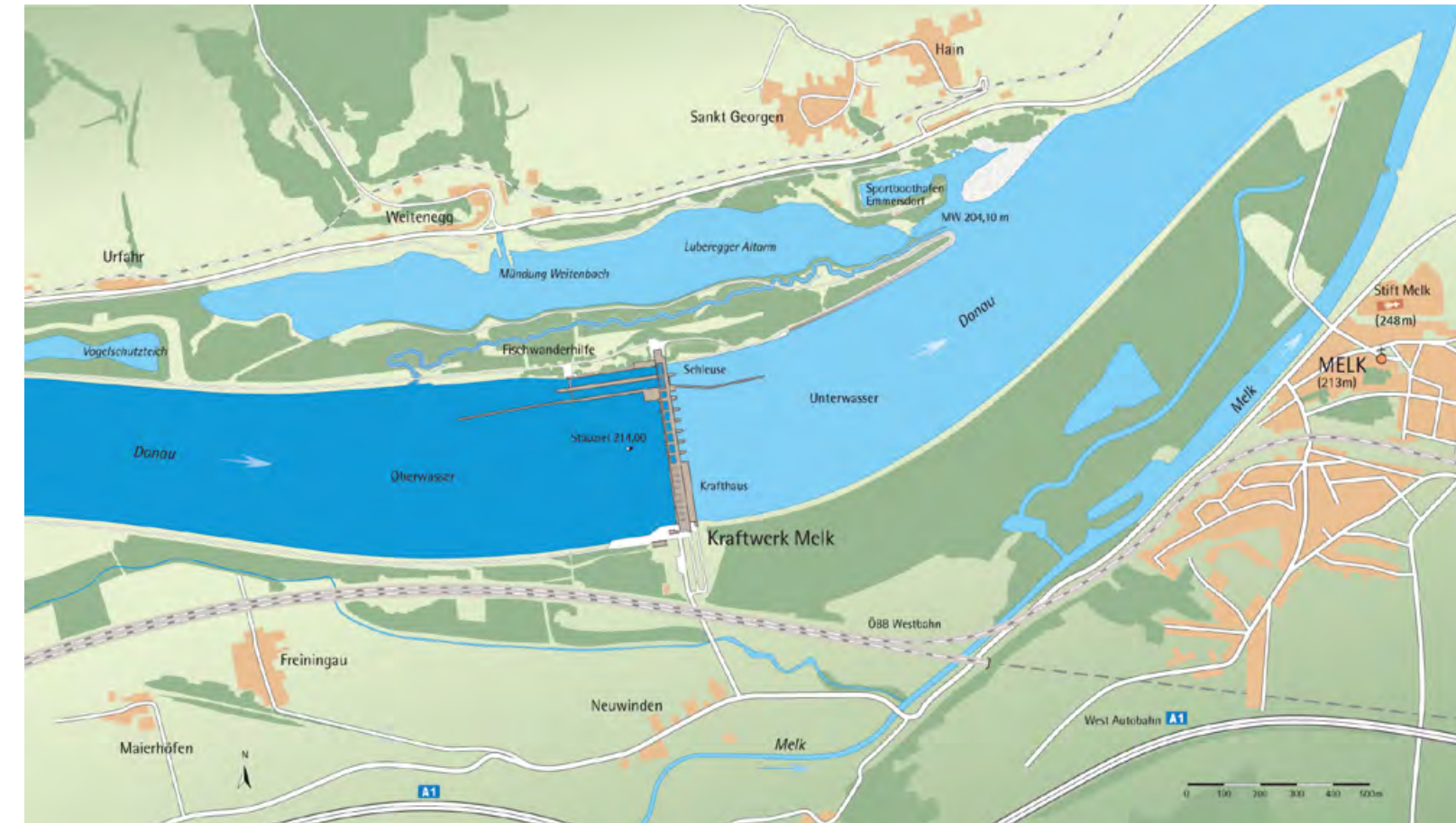
Abb. 1: Übersichtsplan Donaukraftwerk Melk und Umgebung. Die Fischwanderhilfe erstreckt sich über 2 km entlang der schmalen Halbinsel zwischen Donau und Luberegger Altarm.
