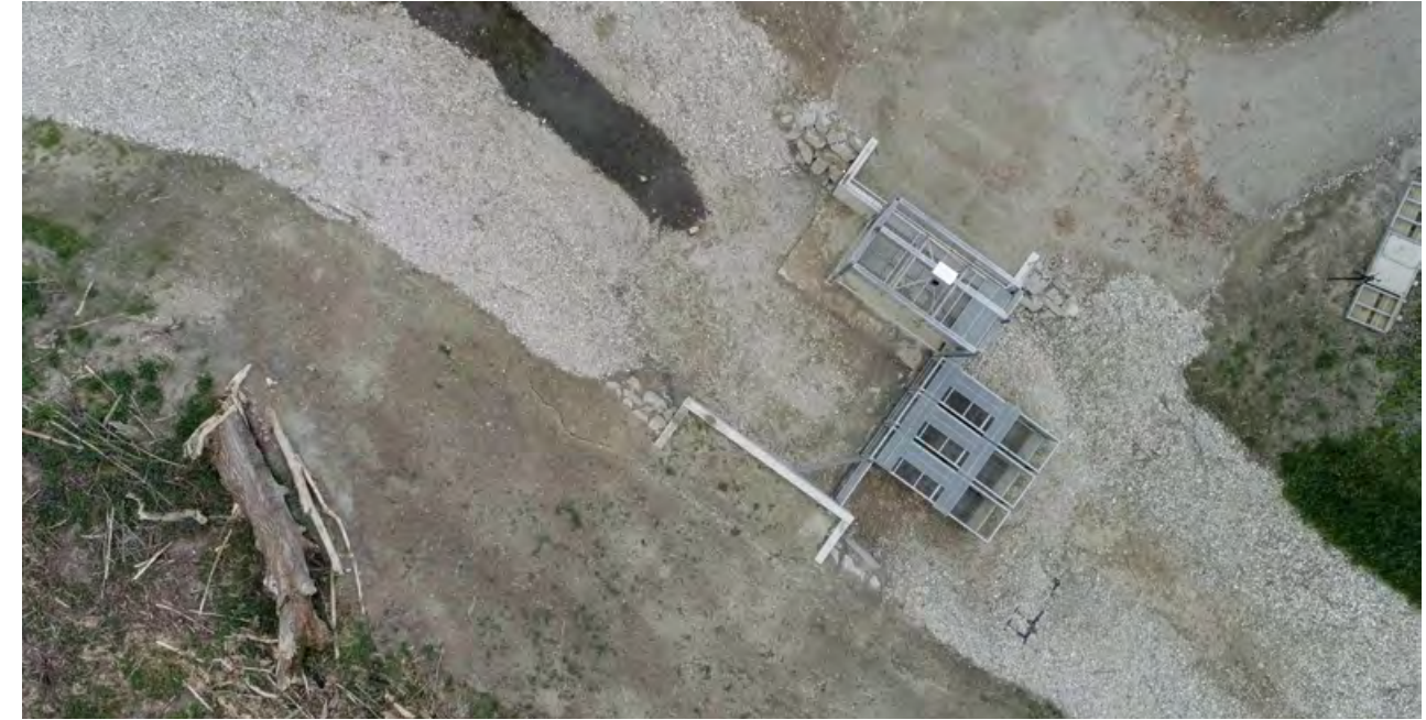
Abb. 10: Die Reuse kurz vor der ersten Benetzung. Es wurde die Reuse aus Greifenstein verwendet, da dort das Monitoring bereits abgeschlossen war. Das Fischwehr ist hier in Form von drei Kästen (im Bild unten) ausgeführt.
