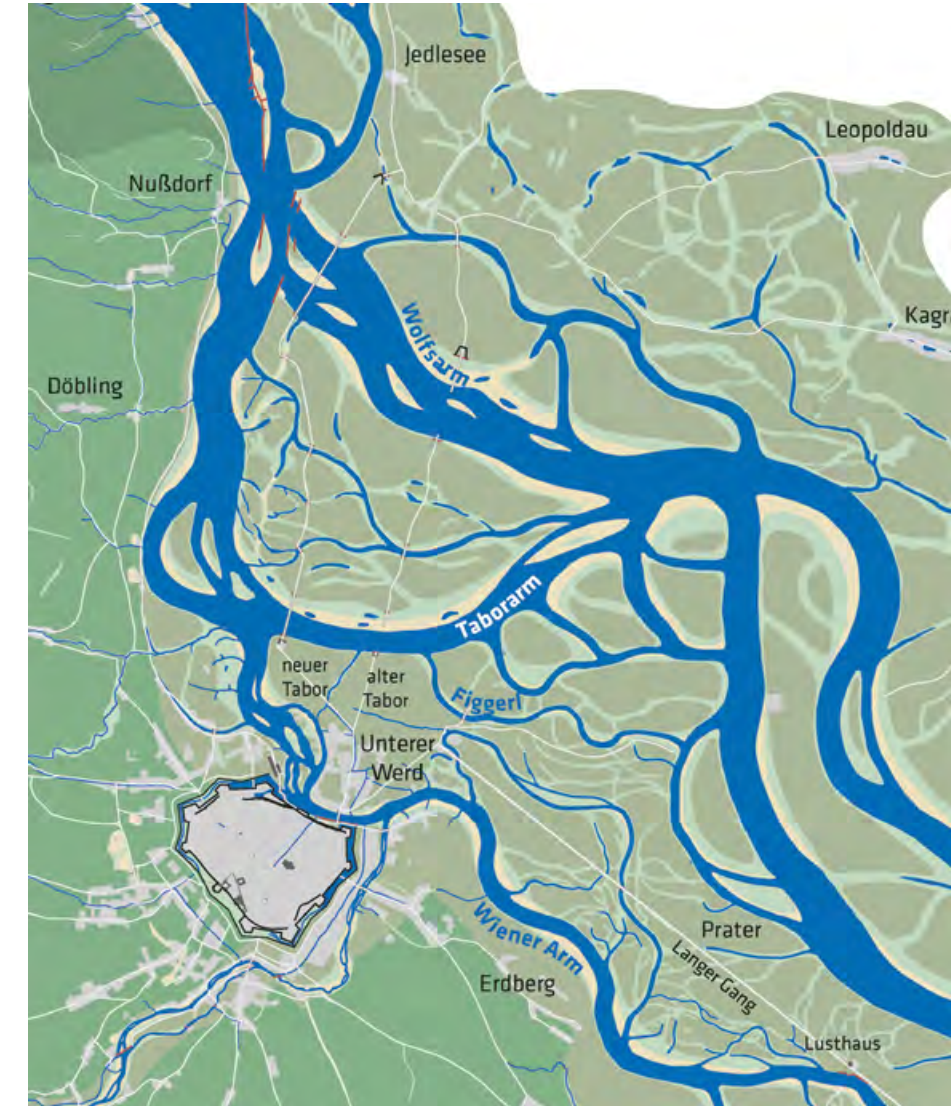
Abb. 3: Um 1570 reagierte die Wiener Donau auf eine merkliche Verschlechterung des Klimas: Der ehemalige stark gewundene Hauptarm, der Taborarm, verlandete allmählich, während mit dem Wolfsarm weiter nördlich ein neuer, breiter und geradliniger Hauptarm entstand. Damals versuchten die Wiener die Verlandung des Taborarms und des Wiener Arms (der heutige Donaukanal) mittels kostspieliger Wasserbauten bei Nußdorf zu verhindern (siehe Zeitraffer-Animation dazu unter: https://youtu.be/dHERpWgA84Y ).
