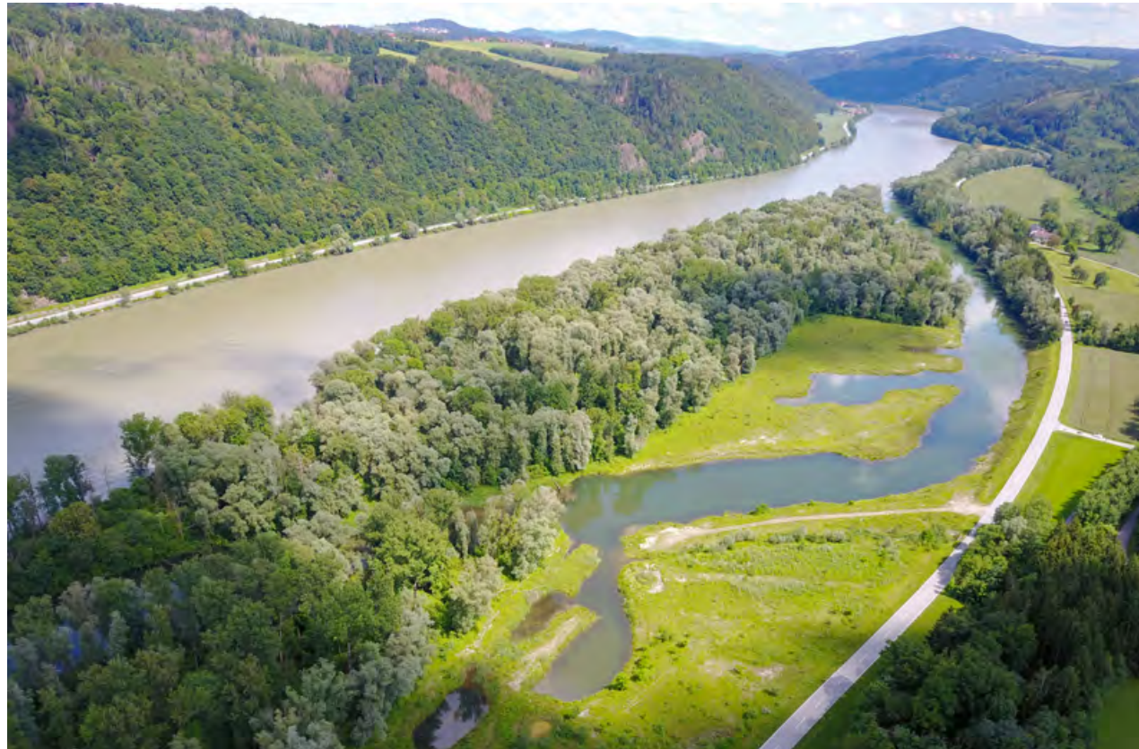
Abb. 12: Durch Freilegen relikitärer Altarme können die Habitatvielfalt und die laterale Konnektivität zwischen Fluss und Au wesentlich verbessert werden. In der Schildorfer Au, im Stauraum des Kraftwerks Jochenstein, wurde eine ehemalige Kiesdeponie abgebaut und der verschüttete Altarm wieder reaktiviert. Weiters wurden isolierte Kleingewässer auf der neuen Auensukzessionsfläche geschaffen.
