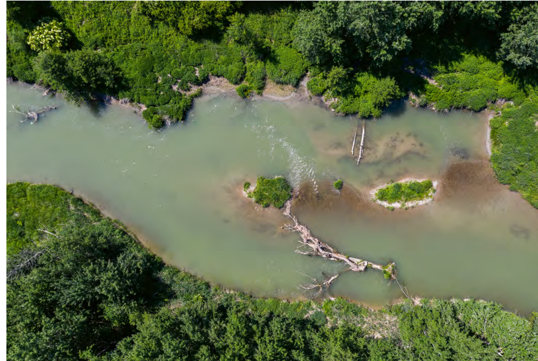
Abb. 2: Naturnah gestalteter Abschnitt in der Aschach, als Teil der Fischwanderhilfe Ottensheim-Wilhering.
