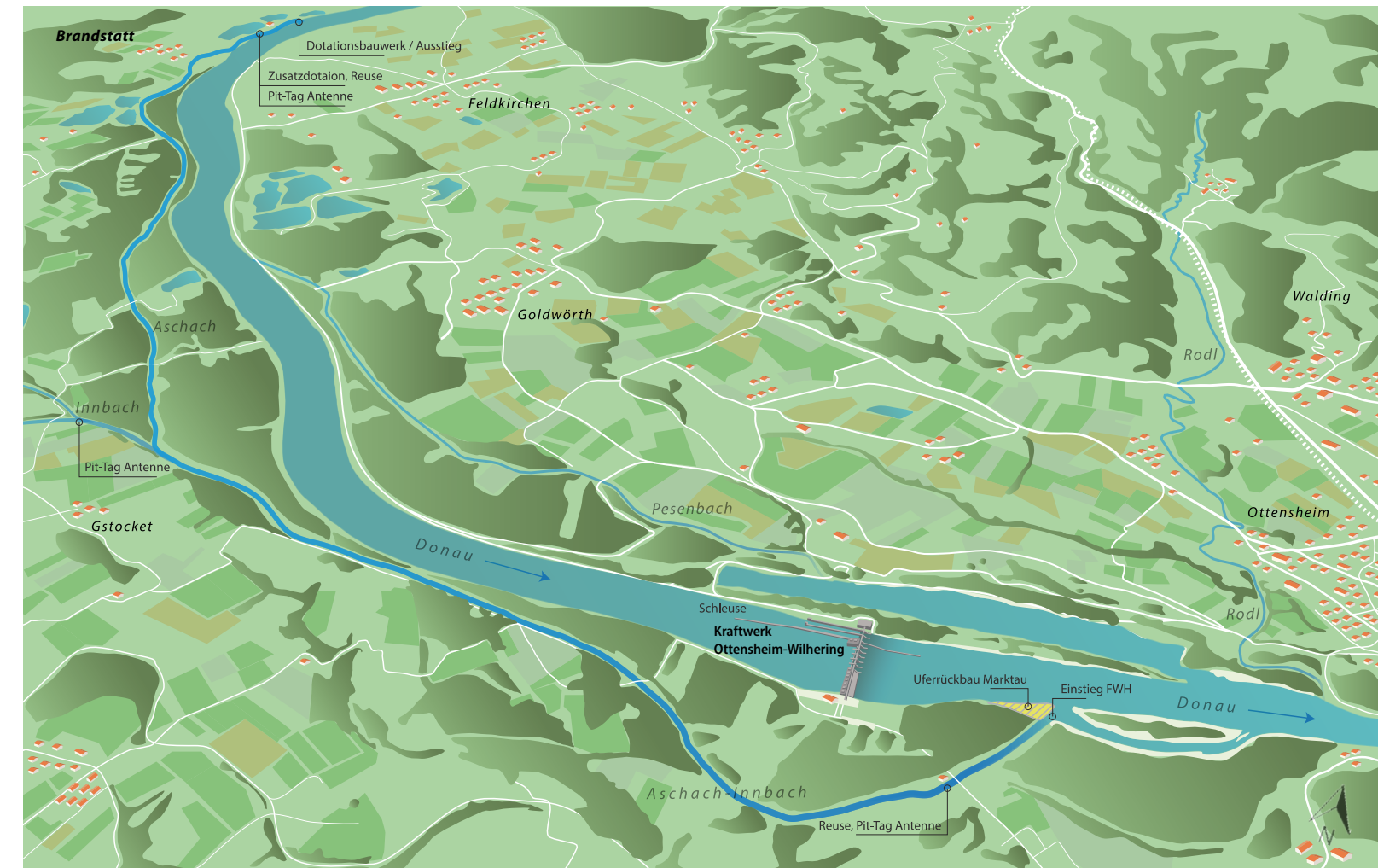
Abb. 1: Schema der Fischwanderhilfe Ottensheim-Wilhering. Bei der Mündung in die Donau wurde der Uferrückbau „Markttau“ realisiert, der die Auffindbarkeit der Wanderhilfe für die Fische verbessert. Das Kraftwerk kann nun von ihnen in einem 14,2 km langen Gerinne umschwommen werden.
