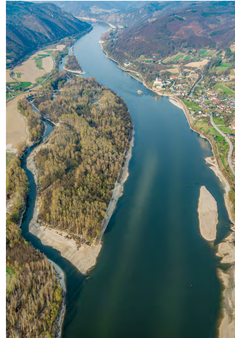
Abb. 9: Im Rahmen mehrerer LIFE Projekte wurden in der Fließstrecke der Wachau zahlreiche leitbildkonforme Revitalisierungsmaßnahmen umgesetzt. Der Hauptarm der Donau wurde mittels geschütteten Kiesbänken und Inseln strukturiert; ein neu gegrabenes, permanent durchströmtes Nebenarmsystem, mit permanentem Wasserfluss, führt nun durch den Auwaldkomplex von Grimsing.
